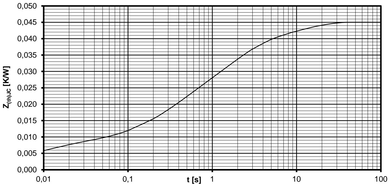
Transienter innerer Wärmewiderstand je Zweig / Transient thermal impedance per arm Z_{thJC} = f(t)
